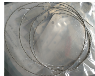
国产 Ti (1mm) V (0.8mm) Zr (1mm) 1:1:1
