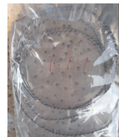
进口 Ti (1mm) V (0.8mm) Zr (1mm) 1:1:1
